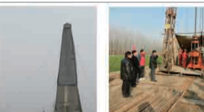
▲2013年12月13日，在市级财政资金的支持下，丰县张河铁矿普查项目ZK03号孔顺利开钻，设计孔深1850米。
